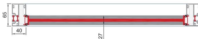
Largura máxima de ventilação: 1600 mm (sem coluna central) Largura máxima NRW: 1300 mm (sem coluna central) altura da lamela: 132 mm (fixo)
