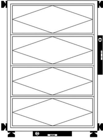
Achten Sie darauf, dass die Spaltmaße zwischen den einzelnen Lamellen und zwischen dem Rahmen und den Lamellen gleichmäßig sind.
