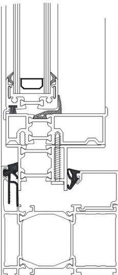
Mit dem entsprechenden Adapter können alle FIEGER Lamellenfenster in bauseitige Fenster-rahmen eingesetzt werden.
