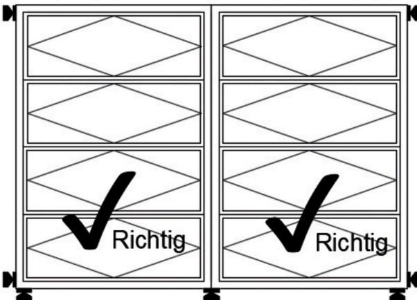
Bei FIEGER Lamellenfenstern mit Mittelpfosten, muss auch unter dem Mittelpfosten verklotzt bzw. unterlegt werden.
