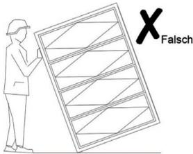
Um mögliche Beschädigungen an Mechanik bzw. Glasbruch zu verhindern, muss das Lamellenfenster formstabil, also kein Verbiegen und Verdrehen, getragen werden. Das Lamellenfenster nicht über die Ecken stürzen.
