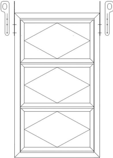
Diese Hebelaschen sind ausschließlich zum Entladen bzw. kurzzeitigen Anhängen und Umsetzen konzipiert.
