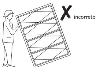
A fim de evitar possíveis danos nos elementos mecânicos ou mesmo a quebra do vidro, a janela de lamelas deve ser mantida dimensionalmente estável, ou seja, não deve ser deformada por efeito de pressão ou torção. Não deixe a janela de lamelas cair sobre os cantos.
