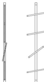
Imagem de um erro típico após o transporte com ventosas aplicadas no vidro!
