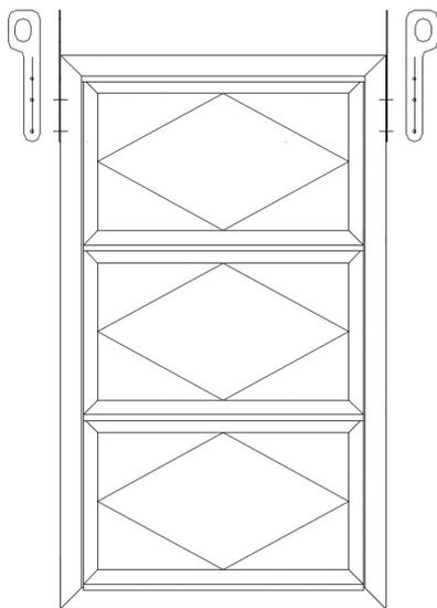
Essas patilhas de elevação são concebidas exclusivamente para descarga ou levantamento rápido para reposicionamento.
