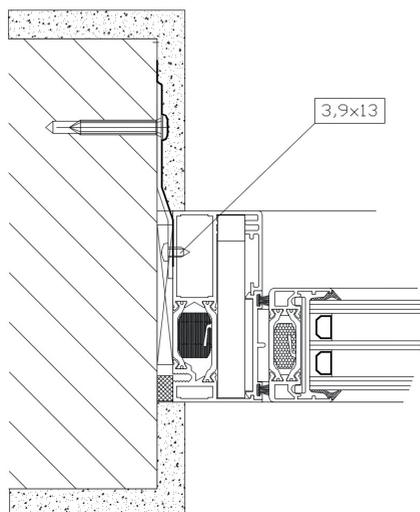
As cavilhas de alvenaria e os parafusos de fixação das cavilhas para alvenaria são fornecidas pela FIEGER.
