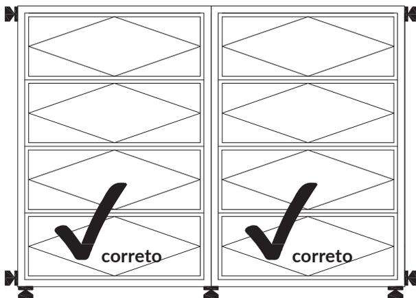
No caso de janelas de lamelas FIEGER com colunas centrais, também devem ser usados calços ou underlays sob a coluna central.
